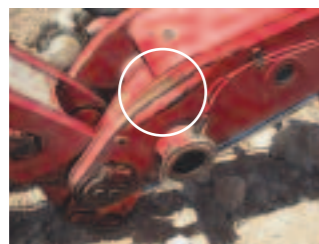
Endommagement dû à un écoulement extérieur entraînant des dommages ultérieurs (fissure)
