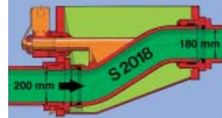
Tuyau en « S » avec passage direct du flux dans les cylindres IP 1082-5 F
