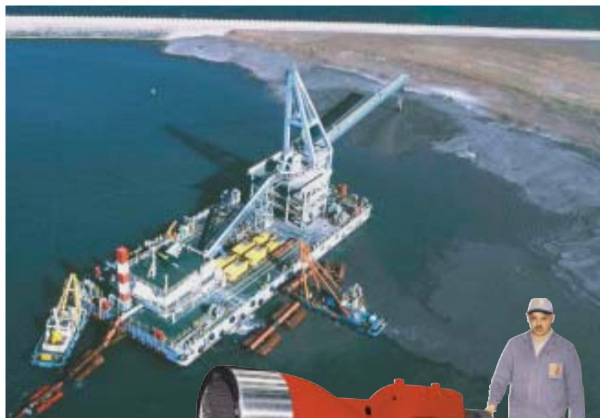
La plus grosse pompe à piston à tuyau en « S » du monde est fabriquée par Putzmeister sous la dénomination KOS 25200. Cette pompe a un débit de 550 m³/h. Elle est utilisée pour gagner du terrain sur la mer sur la côte du Japon.
