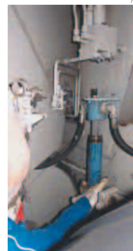
Changement du filtre à huile de flèche
